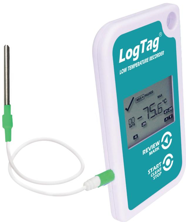
Der LogTag® TREL30-16 Temperatur Datenlogger kann über den externen Fühler bis zu 15,900 Messwerte in einem Messbereich von -90 °C bis +40 °C aufzeichnen.
